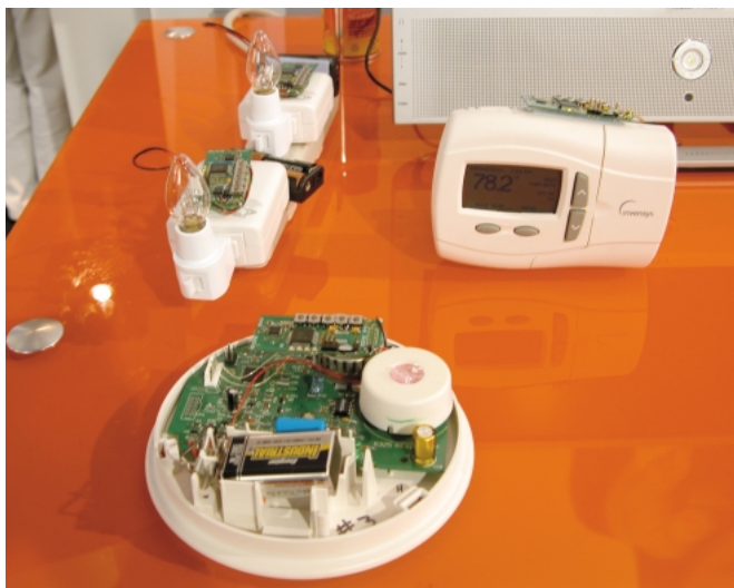
図4 フリースケール・セミコンダクタ社が1月のCESで展示した照明制御用(左上)、空調の温度制御用(右上)、煙検知器用(下)の各種ボード
