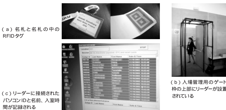
図1 RFIDタグを組み込んだ名札による入場管理
