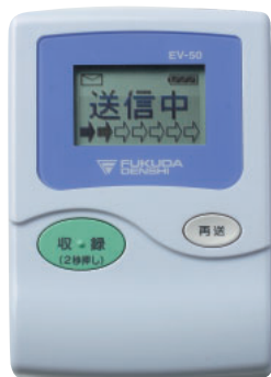
測定後、内蔵のPHSデータ通信を利用して心電図データがセンターに送信される。
