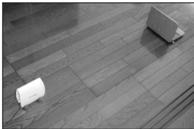
アクセスポイントから1m離れたところで電波強度を測定した。
