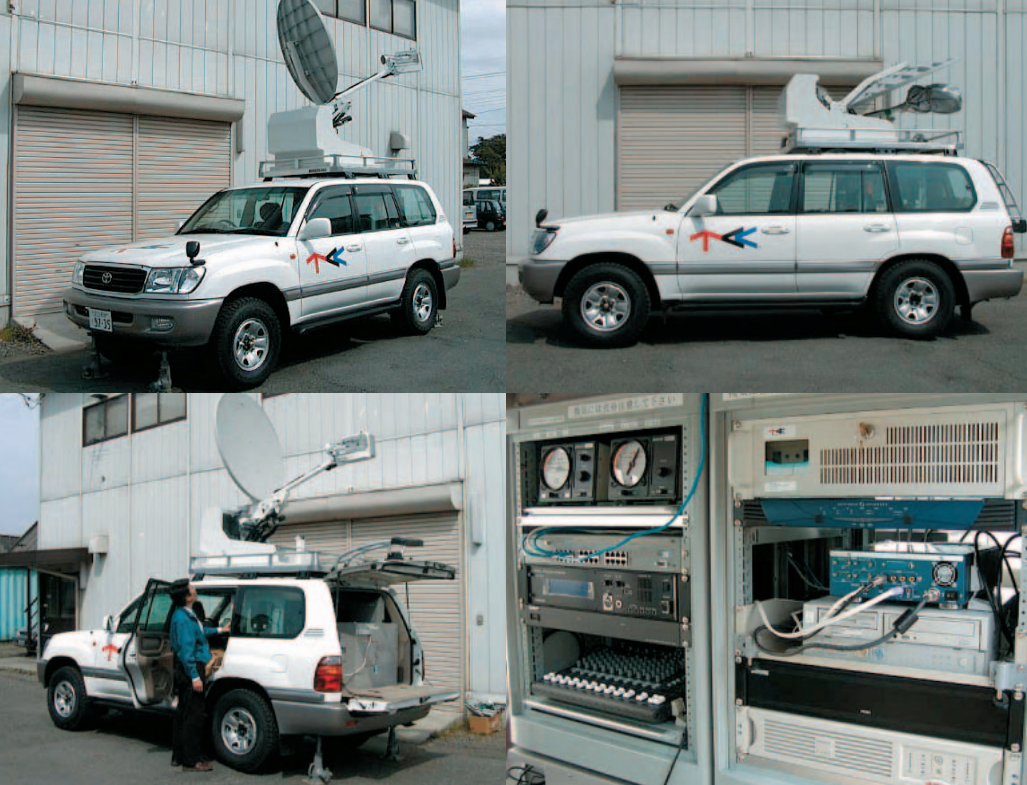
(左上)シャーシの強固さ、山道での走行性などがランドクルーザーを採用した理由だという。(右上)走行中はアンテナが折り畳まれている。(左下)アンテナの展開、方角調整は車内からできる。(右下)2列目のシートを取り外した位置に通信機器類が収められている。右上がIPCastのターミナルユニットだ
