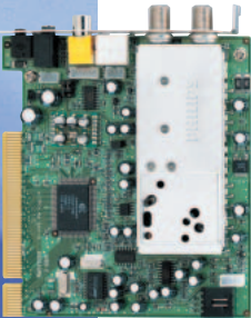
ビデオキャプチャーボード アイ・オー・データ GV-BCTV5/PCI www.iodata.co.jp
