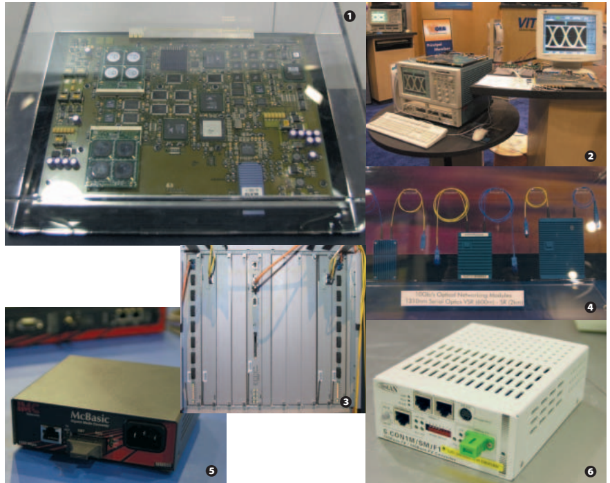
①ファウンドリーネットワークス社の「BigIron」向け10GbEボード。②VITESSE社の10GbEチップVSC7226を搭載したボード2枚によるデータ送受信テスト。③ノータルネットワークスの「Passport 8600」用10GbEボード（左右にある黄色の2線が接続されたもの）。④Network Elementsのオプティカルネットワークモジュール。許容距離によって大きさが異なる。⑤IMCネットワークスのGbE用メディアコンバーター。⑥FibroLANのFE用メディアコンバーター。FTTH市場をも対象にする。
