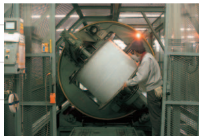
E ファイバーを送るボビンは回転させず、ケーブルの「送り」と「受け」のドラムを周期的に回転させ、SZ撚りの溝にテープファイバーを落とし込む。
