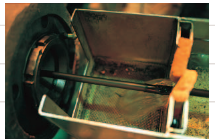
F シースと呼ばれる最後の外部被覆を施されたケーブル。加熱された樹脂の熱が内部に及ぶ前に水冷し、固化させる。
