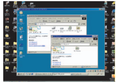
ウィンドウズ2000サーバーではTerminal Serviceが標準で提供される。パワーの低いIPCでもクライアントとして使用できる。
