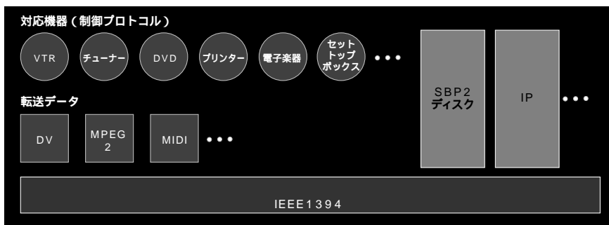
図2 IEEE1394の対応機器とプロトコル
