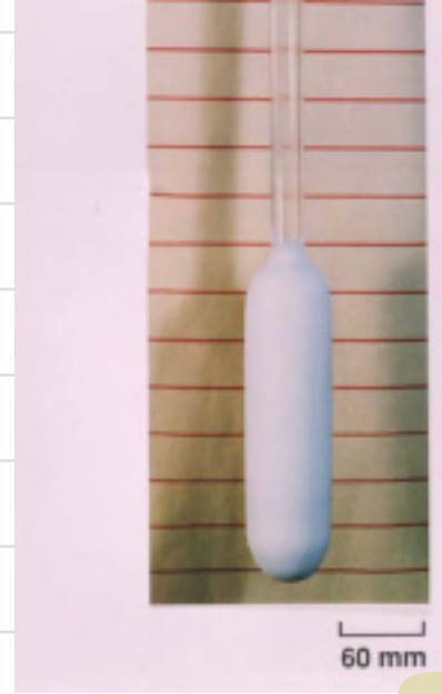
多孔質母材を熱し、スートを融着させて空気を追い出すと、透明な母材ができあがる。これを髪の毛ほどの細さに引き伸ばして、光ファイバーがつけられる。
