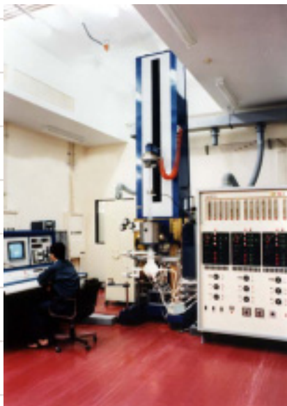
1980年当時のVAD法光ファイバー母材製作装置。
