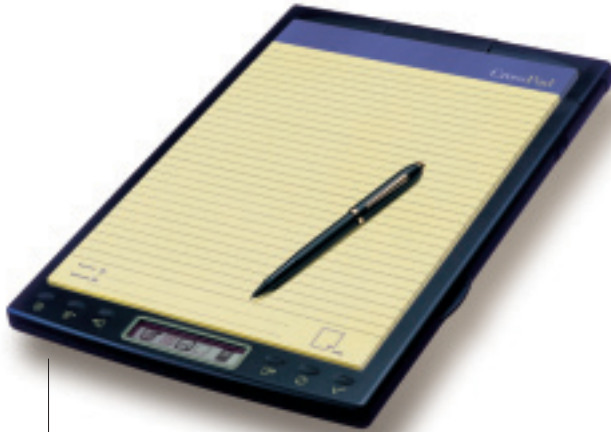
CrossPad本体と専用のボールペン。ペン先から発信される電波を本体が受信して、デジタルデータ化される
