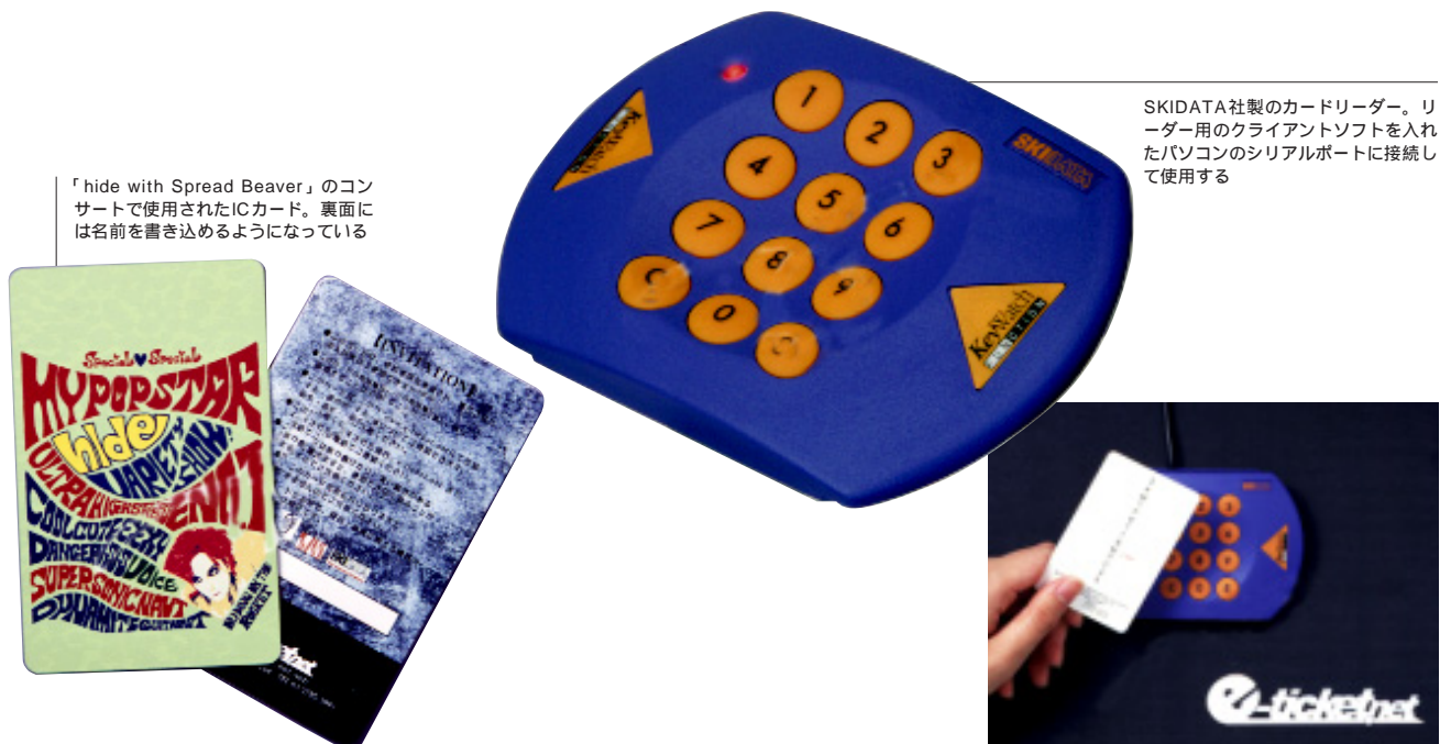
認証はリーダーにICカードを1～2秒かざすだけで完了。紙のチケットのように券面を確認する必要がないので入場に時間がかからない。
