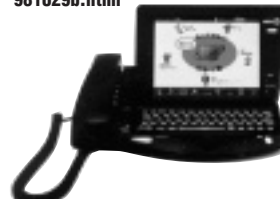
DSUは内蔵せず、最大64Kbpsで通信できる
