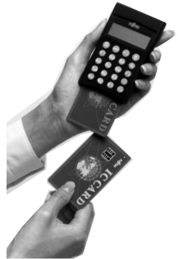
富士通が11月に発売する電子財布「スマートポケット」は、預金口座からICカードに電子マネーを移動（リロード）する機能を持つ。
