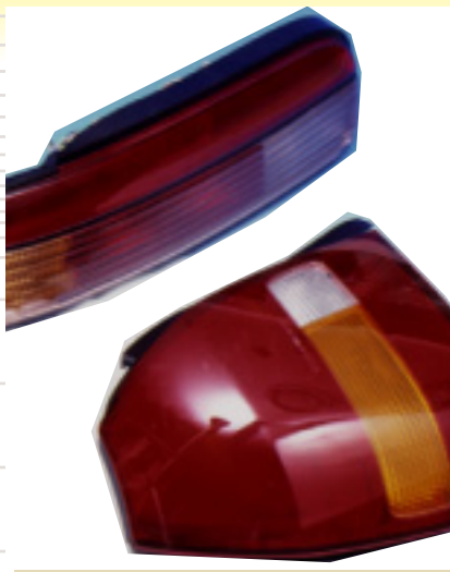
マルチコアPOFの原料となるアクリル樹脂（PMMA）は光が使われる場所に多く使われる素材。写真は自動車のテールランプのカバー部分。
