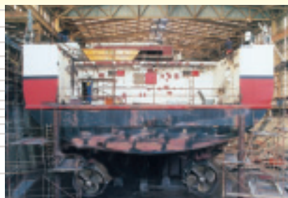
360度回転できる推力33tのプロペラが船尾の左右に2基。従って曳航力も横方向の推進力も後進時の推力も66t。
