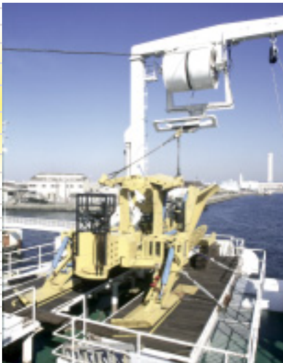
海底の砂地などを掘り返して溝をつくり、その中にケーブルを埋めるための埋設機。
