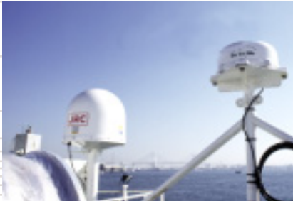
DGPSの受信系はインマルサットを多重化して3系統を装備。
