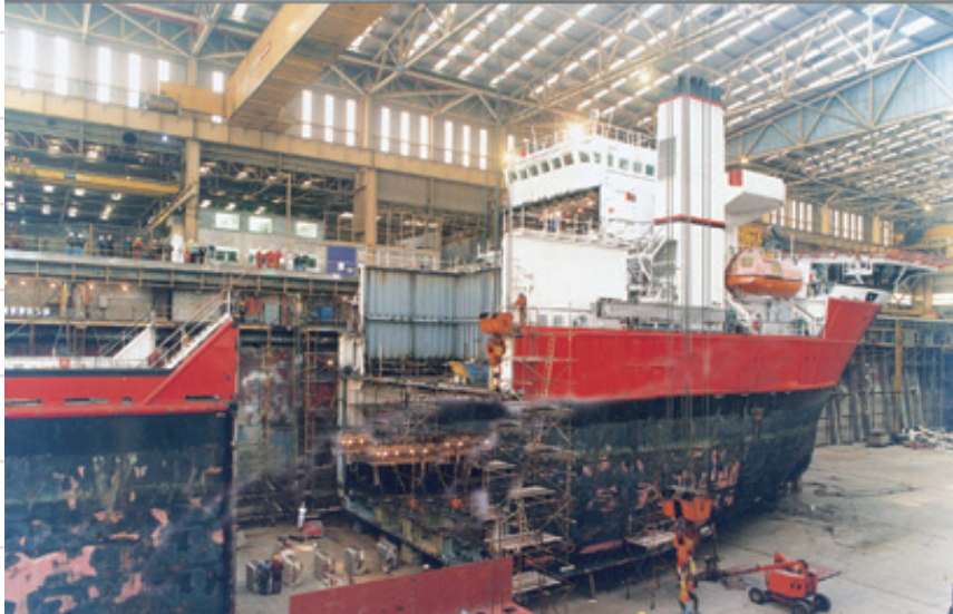
英国のドックでの「割り入れ」作業の様子。船体中央部分が9m延長された。
