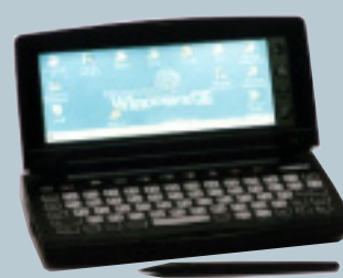
HP 620LX 日本語版 HPのCE 2.0 マシンは、大型キーボードを採用していない。しかし、その分日本のメーカーのものよりもコンパクトにできあがっている。
