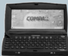
コンパクトCシリーズ コンパクトでは、ウィンドウズCE 2.0 のリリースにあたってモノクロモデルとカラーモデルの2つを用意しており、CPUには両方ともMIPSベースを採用している。
