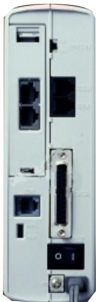
Aterm IT50 DSUの背面。左上の2つのS/TポートがPC-IT/UX1だ。その下はISDN端子と極性反転スイッチ。右側は上から停電スイッチ、アナログポート2つ、RS-232Cポート、電源スイッチ、アース端子。
