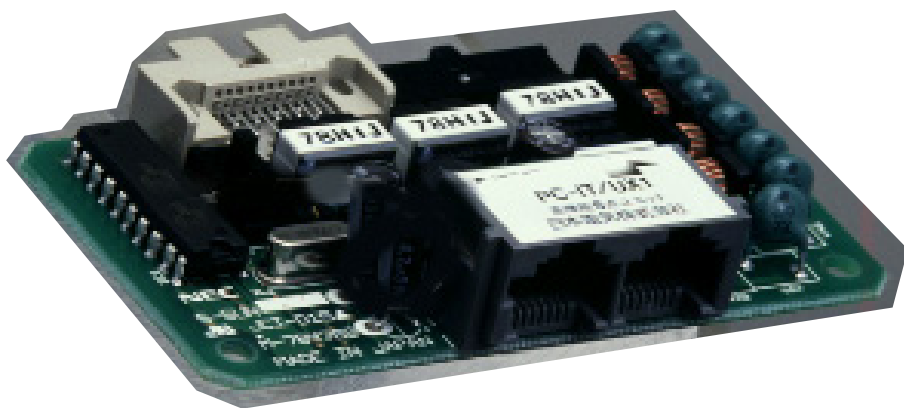
幅10センチほどの高機能S点ユニットのボードには、S/T端子が2ポート備えられている。
