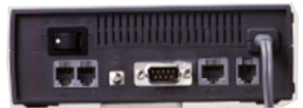
背面。左から、電源スイッチ、アナログポート2つ、アース、S/T端子、RS-232Cポート、ISDN端子。
