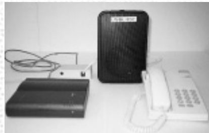
左から端末用のADSLモデム、スプリッター、ラジオ放送用のスピーカー、電話機
