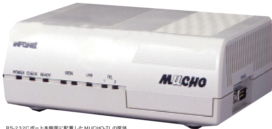
RS-232C ポートを側面に配置した MUCHO-TL の筐体。
