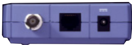
I CRABの左側面。左から、10BASE-2ポート、 10BASE-Tポート、ACアダプター。
