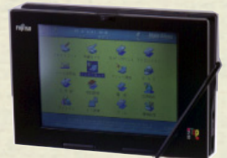
② ディスプレイを360度回転させてペンタッチスタイルでも使用できる。
