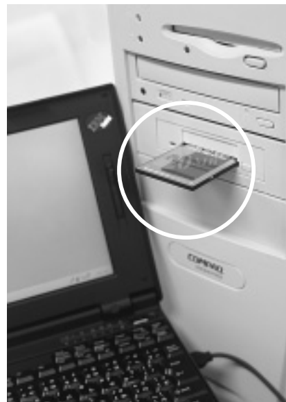
② PCカードスロットが付いたデスクトップ型パソコン。
