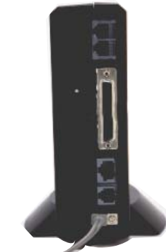
1 上から、アナログポート2つ、電源スイッチ(左)、RS232Cポート(右)、S/T端子、ISDN端子。
