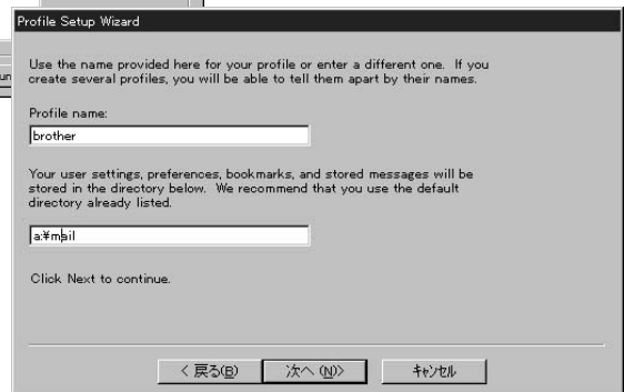
図7 ここでの設定画面で、DOS/Vパソコンの場合、a:¥mailと設定しておく、メールはハードディスクに保存されず、すべてフロッピーディスクに保存されることになる。
