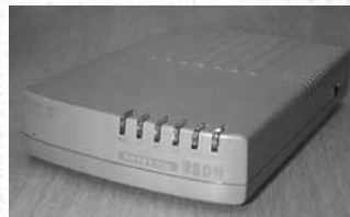
図5: MN128 NTT-TE 東京と㈱ピー・ユー・ジーが共同開発した安価なISDNターミナルアダプター
