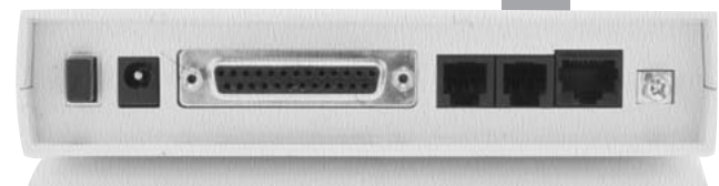
② 裏側から見たところ。左から電源スイッチ、シリアルコネクタ、アナログポート1、アナログポート2、ISDNポート
