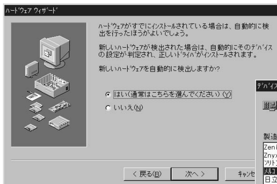
図1 コントロールパネルからハードウェアのアイコンを選ぶと説明が表れ、次へ進むとこの画面に、通常は「はい」を選んで装着したハードを自動検出させる。
