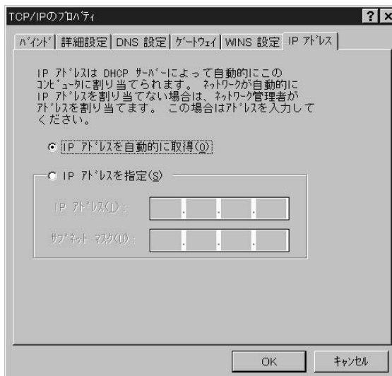
図6 図3「現在のネットワーク構成」から「TCP/IP」を選択して「プロパティ」ボタンをクリックすると、この画面になる。DHCPのあるWindowsNTサーバーへログオンするのでIPアドレスは設定しない。
