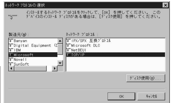
図5 「ネットワークプロトコルの選択」ウィンドウで製造元は「Microsoft」、ネットワークプロトコルは「TCP/IP」を選択。
