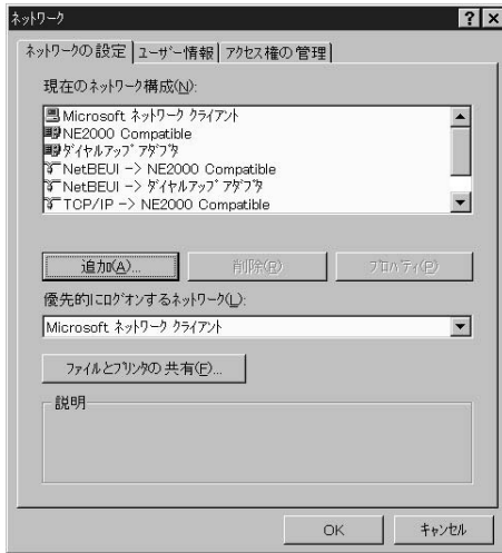
図3 コントロールパネルからネットワークのアイコンを選ぶとネットワークを設定するプロパティが表示される。ここでシートを選んでいろいろな設定をする。
