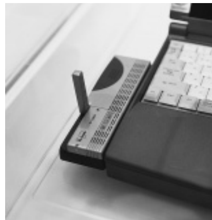
写真1 W-CDMA対応PCMCIAカード(試作例)
