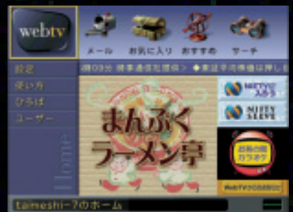
WebTV ブラウザーの画面。専用GD-ROMを利用することにより、DreamcastがWebTVのセットトップボックスとなる。
