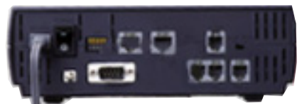
背面。左上から右へ、電源コード、電源スイッチ、ディップスイッチ、S/T端子2つ、DSU切り離しスイッチ、ISDNポート、極性反転スイッチ。左下から右へ、アース端子、RS-232Cポート、アナログポート3つ。
