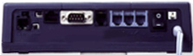
背面。左から、ISDN端子、極性反転スイッチ、S/T端子、RS-232Cポート、ESP端子、アナログポート3つ、電源スイッチ、アース。左上の2つのスイッチはDSUのON/OFFスイッチと終端抵抗スイッチ。
