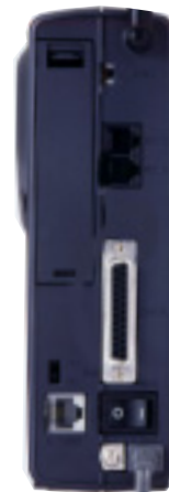
背面。右上から、停電モード設定スイッチ、アナログポート2つ、RC-232Cポート、電源スイッチ、電源コード。左はS/T端子。
