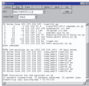
(6) 「Ping」ボタンを押すと、指定したサイトに連続してデータを送って反応が返ってくるまでの時間が表示される。「ms」はミリ秒の略。
