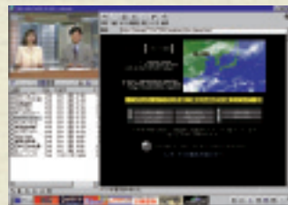
① ビットキャストの受信画面。左上はTV放送の画面で、通常のTV電波の隙間を利用してHTML情報が配信される。
