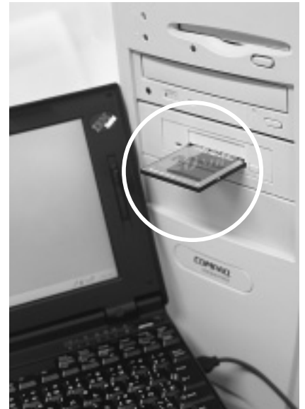
② PCカードスロットが付いたデスクトップ型パソコン。
