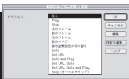
図21：ほかのページにジャンプするボタンのためのアクション「Get URL」の記述。ネットワークURLの枠内にジャンプ先を記述する。URLは、絶対指定でも相対指定でもよい。
