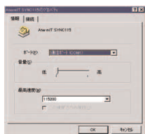
1 「コントロールパネル」で「モデム」を選択し、「プロパティ」をクリックする。モデムがどのCOMポートにつながっているかを確認する。
