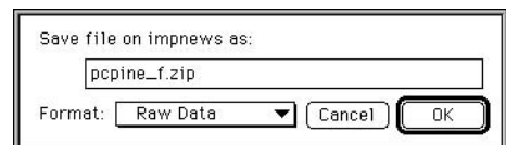
図2 図1の設定をしない場合でも、ファイルをブットするときのダイアログでFormatを指定するポップアップメニューがあるので、ここでマックバイナリーではなく、Raw data形式を選ぶ。
