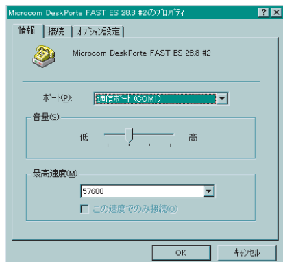
図④: [マイコンピュータ] [ダイヤルアップネットワーク]で個別のネットワークのアイコンを選んでマウスを左クリックし、「プロパティ」[設定]と選ぶとモデムの設定ができる
